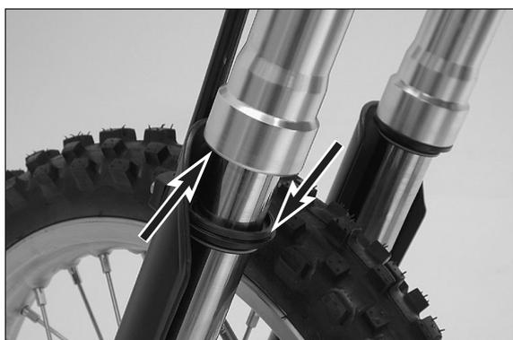
Staubmanschetten, Außenrohre und Gabelholme gründlich reinigen und mit Silikonspray oder Motoröl gründlich einölen. Abschließend die Staubmanschetten mit der Hand in die Außenrohre drücken.
