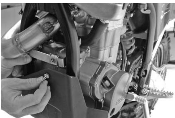
Enganchar el protector del motor, introduciendo la lengüeta entre el motor y el chasis, y bascularlo hacia delante. Fijar el protector del motor al estribo de sujeción, girando un cuarto de vuelta el cierre rápido, y apretar a fondo los tornillos de cabeza hexagonal del estribo de sujeción.
