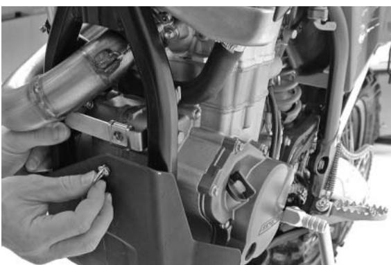
A l'aide de la patte de fixation, accrocher la protection moteur entre le moteur et le cadre, puis la rabattre vers le haut. Par un quart de tour, fixer la protection moteur à l'étrier de fixation, à l'aide de la fixation rapide et serrer fermement les vis à six pans de l'étrier de fixation.
