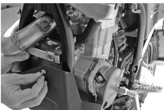
Motorschutz mit der Lasche zwischen Motor und Rahmen einhängen und nach vorne hochklappen. Motorschutz mit dem Schnellverschluß am Befestigungsbügel durch eine Viertelumdrehung fixieren und Sechskantschrauben des Befestigungsbügels festziehen.
