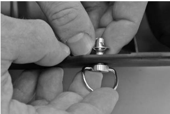
Inserire la chiusura rapida dall'esterno attraverso il foro sulla paratia del motore e inserire dall'interno l'anello di sicurezza sulla chiusura rapida sino a farlo scattare in posizione.
