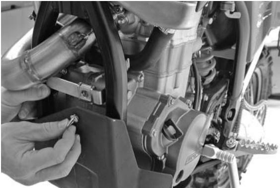
Agganciare la paratia del motore con l'aletta? posizionata tra motore e telaio e sollevarla in alto. Fissare la paratia del motore con la chiusura rapida facendo un quarto di giro e avvitare le viti esagonali della staffa.
