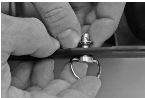
Pasar el cierre rápido desde el exterior a través del taladro en el protector del motor y colocar el anillo de retención desde el interior por encima del cierre rápido, hasta que encastre .
