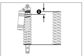
ADJUSTMENT VALUES - SPRING PRELOAD 4 minimum preload . . . . . . . . . . . . . . . . . 4 mm (0,15 in)
