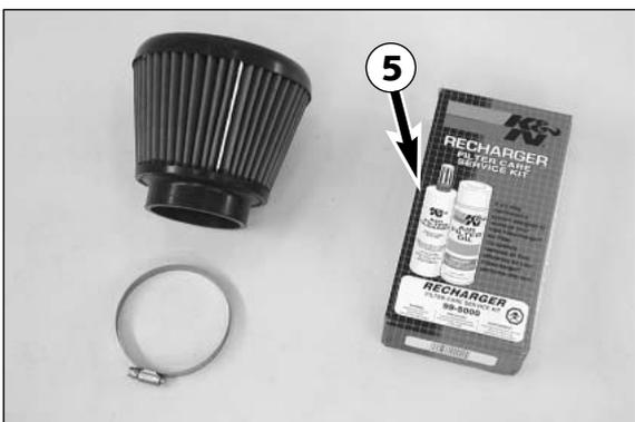
Luftfilter mit spezieller Reinigungsflüssigkeit gründlich waschen und gut trocknen lassen. Trockenen Luftfilter mit K&N Filteröl einölen. Luftfilterkasten ebenfalls reinigen. Vergasermanschette auf Beschädigungen und festen Sitz prüfen.
