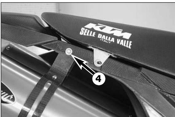
Zum Abnehmen des Enddämpfers lösen Sie die Schraube ❹ und ziehen diesen nach hinten weg.
