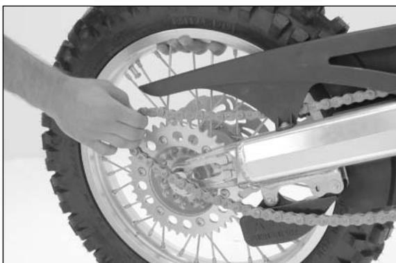
Der Einbau erfolgt in sinngemäß umgekehrter Reihenfolge. Vor dem Festziehen der Bundmutter mit 80 Nm, das Hinterrad nach vorne drücken, damit die Kettenspanner an den Spannschrauben anliegen.
