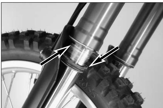
Staubmanschetten, Außenrohre und Gabelholme gründlich reinigen und mit
