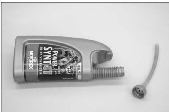
Um Ihnen das Entlüften des Ölsystems zu erleichtern, haben wir dem Bordwerkzeug ein Schlauchanschlußstück und einen Kunststoffschlauch zum Bau eines Befüllungswerkzeuges beigelegt. Nehmen Sie eine leere Öldose (1 Liter) und bohren Sie ein Loch mit  $\varnothing$  7mm in den Verschlußdeckel. Schrauben Sie das Schlauchanschlußstück von außen in den Verschlußdeckel und kontern Sie mit der Sechskantmutter M8 von innen. Stecken Sie den Kunststoffschlauch auf das Schlauchanschlußstück.
