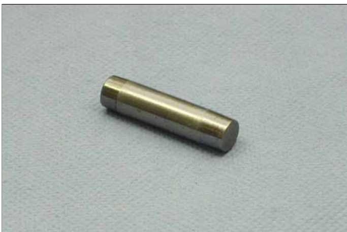
T14.021. Calibrate mandrel DU-bush d12.
