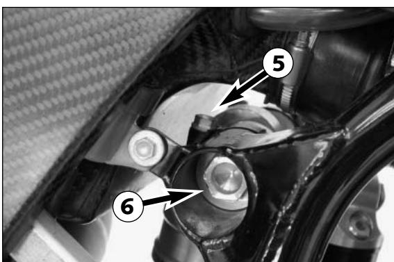
Zum Verstellen der Heckhöhe die Klemmschrauben ⑤ lockern. Einen Steckschlüssel 19 mm auf den Sechskant ⑥ stecken und Exzenter entsprechend verdrehen. Ausgehend von der Standardeinstellung, den Exzenter maximal 90° nach oben bzw. 90° nach unten verdrehen. Der Verstellbereich beträgt ± 24 mm am Hinterrad.
