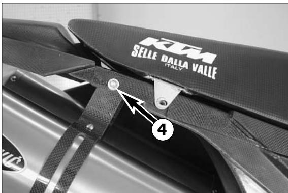
Zum Abnehmen des Enddämpfers lösen Sie die Schraube 4 und ziehen diesen nach hinten weg.
