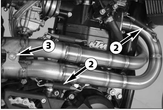
Den Krümmer entfernen Sie indem Sie die beiden Federn 2 aushängen und die Schraube 3 entfernen.
