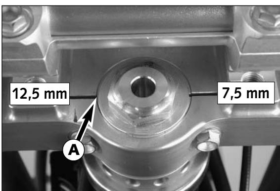
Ist die Nut ④ links, beträgt der Versatz 12,5 mm und der Nachlauf 97,4 mm. Mit dieser Einstellung erzielen Sie besseres Handling in Kurven.
