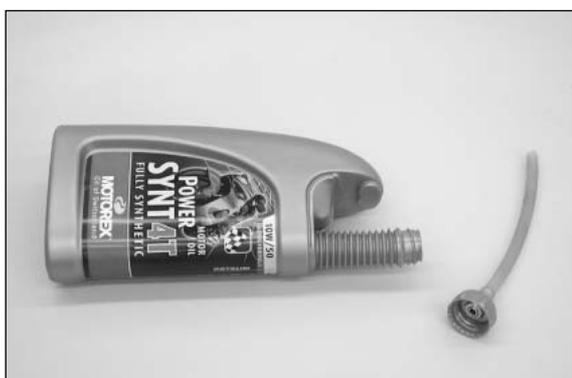
Um Ihnen das Entlüften des Ölsystems zu erleichtern, haben wir dem Bordwerkzeug ein Schlauchanschlußstück und einen Kunststoffschlauch zum Bau eines Befüllungswerkzeuges beigelegt. Nehmen Sie eine leere Öldose (1 Liter) und bohren Sie ein Loch mit  $\varnothing$  7mm in den Verschlusdeckel. Schrauben Sie das Schlauchanschlußstück von außen in den Verschlusdeckel und kontern Sie mit der Sechskantmutter M8 von innen. Stecken Sie den Kunststoffschlauch auf das Schlauchanschlußstück.
