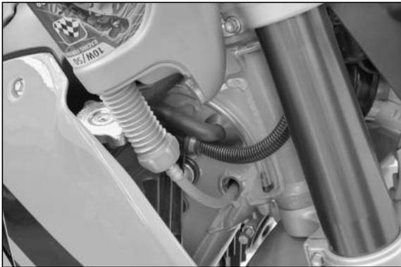
Motor warmlaufen lassen, Ölablaßschrauben und Feinfilter auf Dichtheit prüfen und Motorölstand kontrollieren. Dazu Motorrad auf waagrechte Fläche aufrecht stellen. Motorölstand kontrollieren, darf aber keinesfalls die MAX-Markierung überschreiten, da sonst Motoröl über die Motorentlüftung in den Luftfilterkasten gelangt. Nötigenfalls Motoröl nachfüllen.
