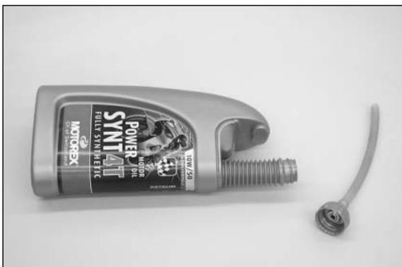
Um Ihnen das Entlüften des Ölsystems zu erleichtern, haben wir dem Bordwerkzeug ein Schlauchanschlußstück und einen Kunststoffschlauch zum Bau eines Befüllungswerkzeuges beigelegt. Nehmen Sie eine leere Öldose (1 Liter) und bohren Sie ein Loch mit Ø 7mm in den Verschußdeckel. Schrauben Sie das Schlauchanschlußstück von außen in den Verschußdeckel und kontern Sie mit der Sechskantmutter M8 von innen. Stecken Sie den Kunststoffschlauch auf das Schlauchanschlußstück.
