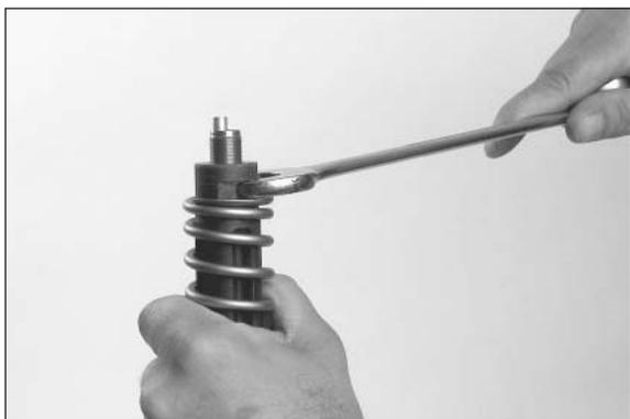
– Feder nach unten ziehen und Schlüssel entfernen.
