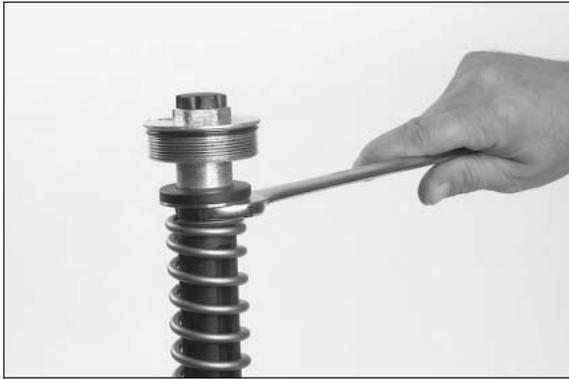
– Gabelschlüssel (SW22) am Hydraulik-Stop ansetzen.
