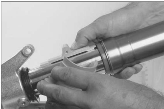
– Spezialwerkzeug T502S umdrehen und für die Montage des Öldichtrings verwenden.
