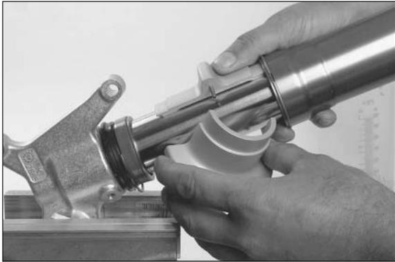
– Führungsbüchse Außenrohr mit der flachen Seite von T502S montieren.
