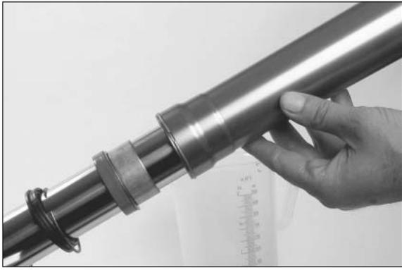
– Außenrohr montieren.
