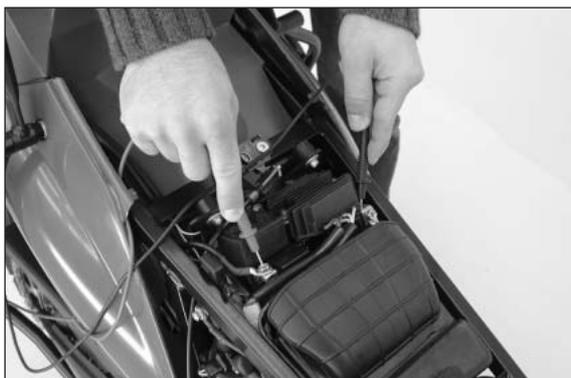
**Reglerausgang** – Spannungswert mit den Meßspitzen des Spitzenspannungsadapters direkt an den Polen der Fahrzeugbatterie messen:
