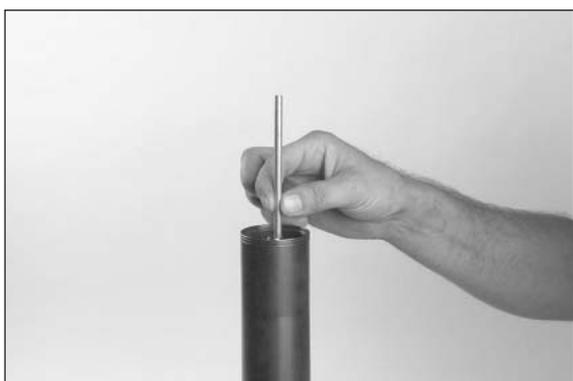
– Justierrohr mit O-Ring aus der Kolbenstange nehmen.
