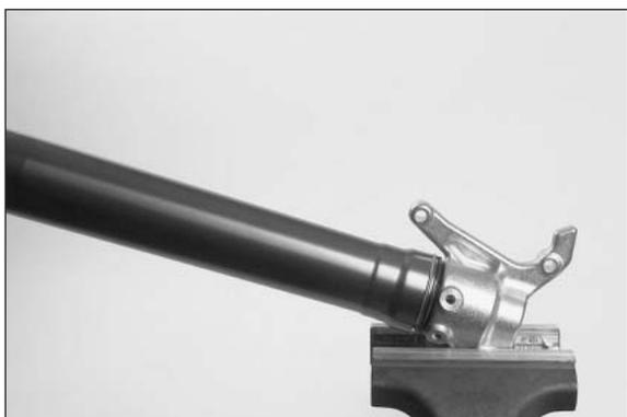
– Gabelholm schräg in einen Schraubstock spannen.
