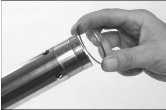
– Sicherungsring entfernen.
