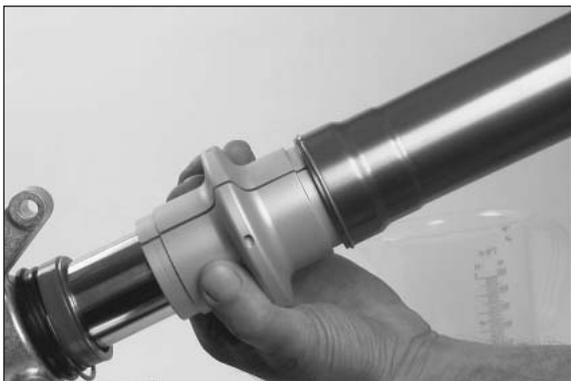
– Führungsbüchse in das Außenrohr drücken.
