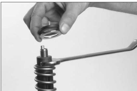
– Vorspannbüchse(n) entfernen.
