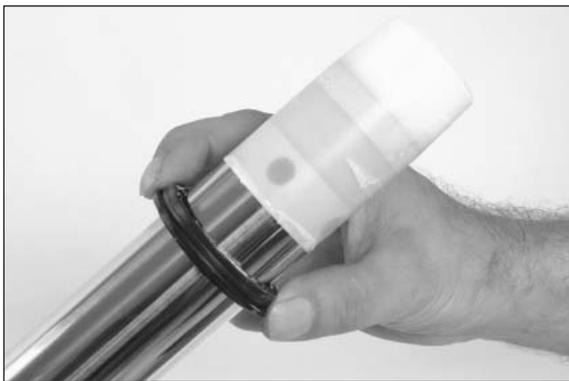
– Spezialwerkzeug T512 auf dem Gabelholm anbringen. Danach Staubmanschette auf das Innenrohr schieben.
