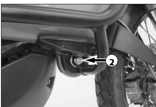
Fixer le pare-chocs sur le côté au niveau du réservoir avec les vis six pans creux M8x70 et en mettant une rondelle à chaque fois ②.
