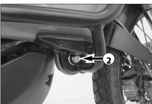
Verschrauben Sie den Bügel seitlich am Tank mit den M8x70 Innensechskantschrauben und je einer U-Scheibe ②.
