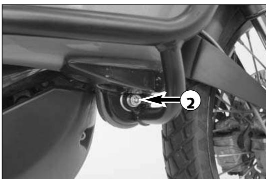
Avvitare la staffa di protezione sul lato mediante una vite TCEI M8x70 ed una rondella M8 ② al serbatoio.
