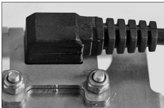
Enfiler alors la prise par en dessous dans le logement et fixer avec les vis à tête fraîsée M3x10 et les écrous autobloquants. Le fil sort sur la droite. Remettre la plaque du dessous et fixer le support sur la moto. L'alimentation se fait par un plus pris après le contacteur à clef.
