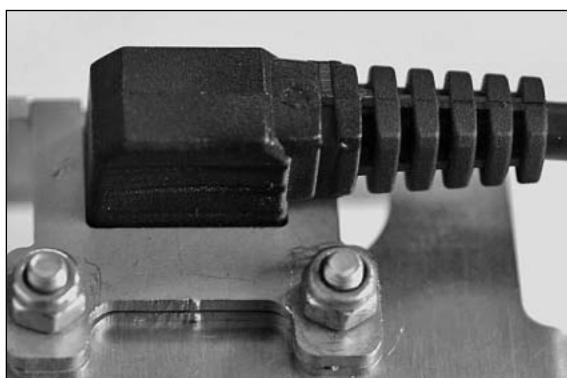
Ahora introducir la terminal desde abajo en la escotadura y atornillarla con los tornillos de cabeza rebajada M3 x 10 y las tuercas autofijadoras. Durante este procedimiento el cable indica hacia la derecha afuera del soporte. Atornillar de nuevo la placa de sujeción y montar el soporte en el vehículo. La conexión eléctrica debería efectuarse en el plus después de la cerradura de encendido.
