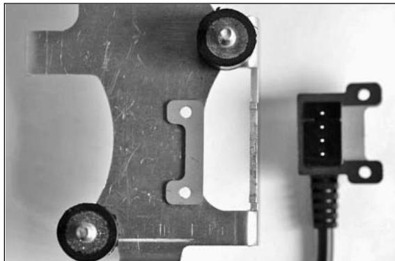
Tra il supporto del connettore ed il supporto dell'apparecchio deve essere montata la piastra distanziante per evitare danneggiamenti del connettore all'inserimento dell'apparecchio.
