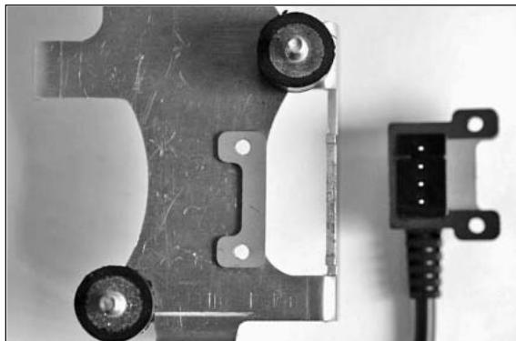
Entre los soportes de cable y el soporte del dispositivo tiene que ser montada una placa distanciadora. De no ser así se podría dañar la terminal de conexión al introducir el dispositivo.
