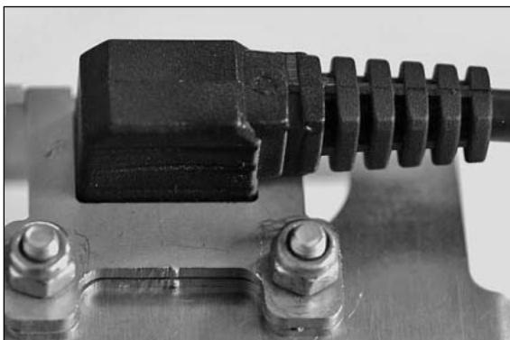
Jetzt den Stecker von unten in die Aussparung einstecken und mit den M3 x 10 Senkkopfschrauben und selbstsichernden Muttern verschrauben. Das Kabel weist dabei nach rechts aus dem Halter heraus. Halteplatte wieder anschrauben und Halter am Fahrzeug montieren.
