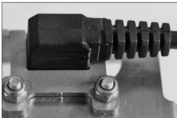
Ora inserire il connettore dal basso nell'apertura e avitarlo con le viti TS M3x10 ed i dadi autobloccanti. Il cavo deve uscire a destra dal supporto. Riavvitare la piastra di supporto e montare il supporto completo sul veicolo. Il collegamento elettrico deve avvenire al positivo sotto chiave. Montare il supporto mediante la fascetta serratubo prevista sul lato inferiore del supporto sul traversino del manubrio oppure sull'adeguato adattatore di montaggio.
