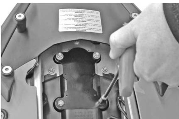
Montageblech hinten mit den Bundschrauben M5x16 und den Scheiben A5,3 und vorne mit den Bundschrauben M5x20 verschrauben.
