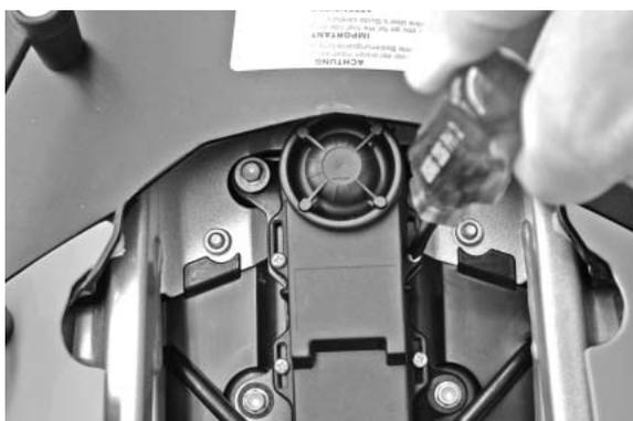
Relier l'alarme au faisceau. Recouvrir la prise avec le capuchon. Fixer l'alarme sur la tôle support au moyen de quatre vis à tôle à tête bombée 3,5x16.
