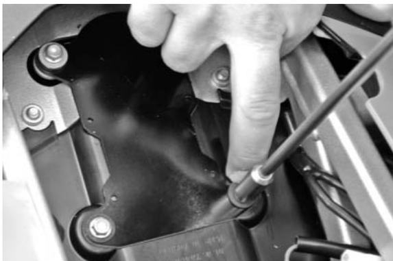
Si les passe-fil tournent quand on visse, il faut les tenir avec le doigt, comme cela est indiqué sur l'illustration. Serrer les vis sans forcer, juste de manière à ce que la tôle tienne en place.
