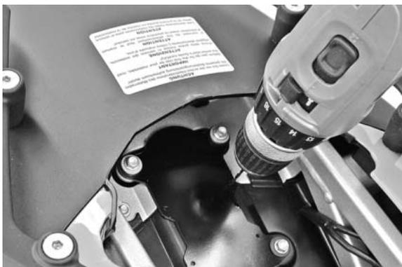
Avec précaution percer à 2,5 mm à travers les quatre trous de la tôle support. Ne pas percer trop profond afin de ne pas abîmer le garde-boue qui est juste en dessous.
