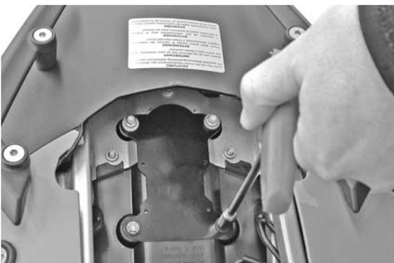
Avvitare la piastra di supporto dietro con le viti flangiate M5x16 e le rondelle A5,3 e davanti con le viti flangiate M5x20.
