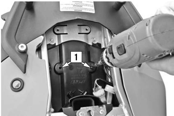
Quitar el banco de asiento y retirar la herramienta de a bordo del compartimiento auxiliar. Perforar cuidadosamente los dos agujeros del compartimiento auxiliar (1) con un taladro de 10 mm. No perforar demasiado profundo para no dañar el guardafangos subyacente. Desbarbar las perforaciones con una herramienta adecuada.
