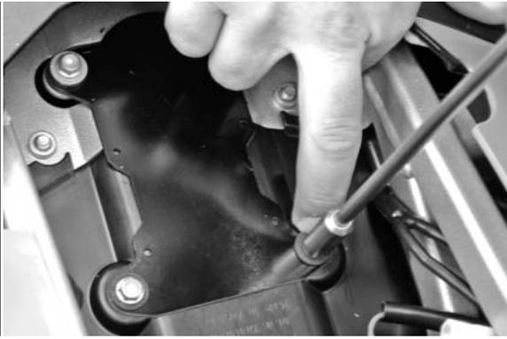
Sollten sich die Gummitüllen beim Verschrauben mitdrehen, mit dem Finger, wie im Bild gezeigt, gegenhalten. Schrauben gefühlvoll anziehen bis das Montageblech festen Sitz hat.
