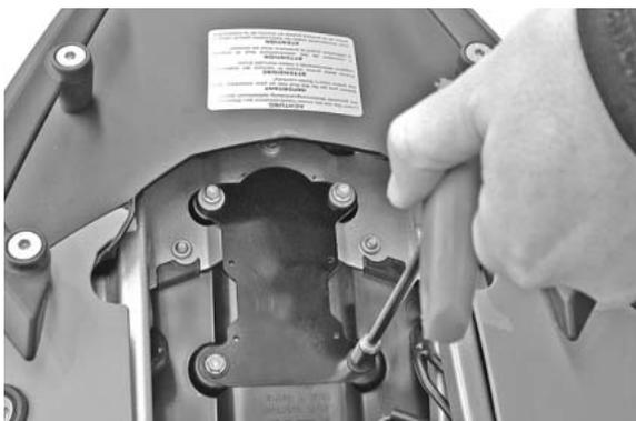
Atornillar la chapa de montaje atrás con los tornillos collar M5x16 y las arandelas A5,3 y adelante con los tornillos collar M5x20.
