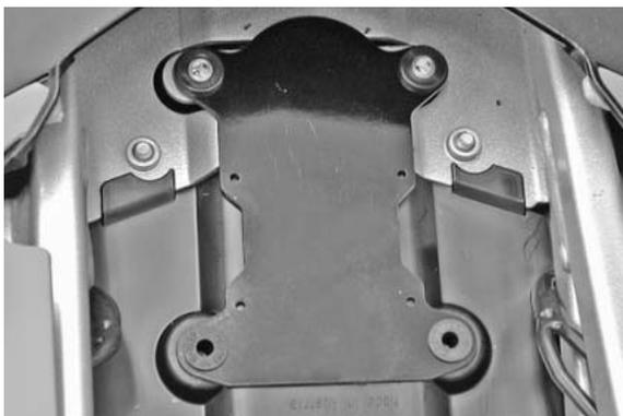
Montageblech, wie im Bild gezeigt, in das Staufach einsetzen.
