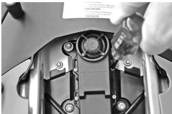
Conectar el dispositivo de alarma con el tramo de cables. Sacar la boquilla de protección por encima del dispositivo de alarma. Atornillar en la chapa de montaje el dispositivo de alarma con los cuatro tornillos de cabeza alomada para la chapa 3,5x16.
