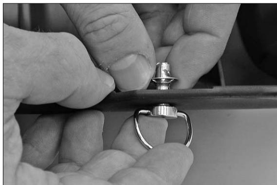
Schnellverschluß von außen durch die Bohrung am Motorschutz stecken und den Sicherungsring von innen über den Schnellverschluß schieben bis er einrastet.
