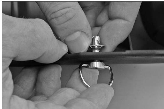
Introduire, de l'extérieur, la fixation rapide dans le trou de la protection moteur et, de l'intérieur, enfoncez l'anneau de sécurité sur la fixation rapide jusqu'à ce qu'il s'enclenche.
