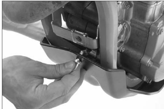
Aggiicare la paratia del motore con l'aletta? posizionata tra motore e telaio e sollevarla in alto. Fissare la paratia del motore con la chiusura rapida facendo un quarto di giro e avvitare le viti esagonali della staffa.
