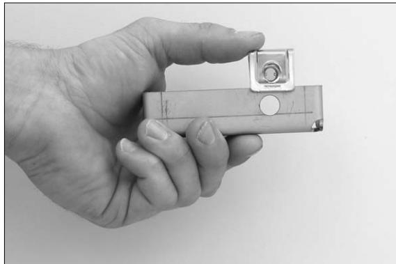
Schnellspannclip auf den Befestigungsbügel aufschieben bis er einrastet.
