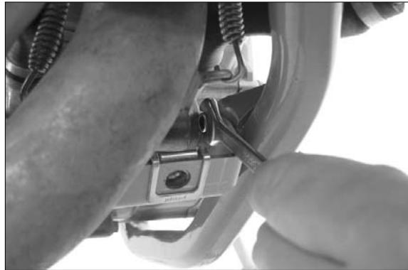
A l'aide des vis à six pans et des écrous, monter l'étrier de fixation sur le cadre. Ne serrer les vis que jusqu'à ce que l'étrier ne puisse plus bouger.
