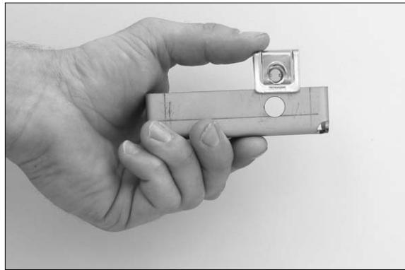
Enfoncer le clip de tension rapide sur l'étrier de fixation jusqu'à ce qu'il s'enclenche.
