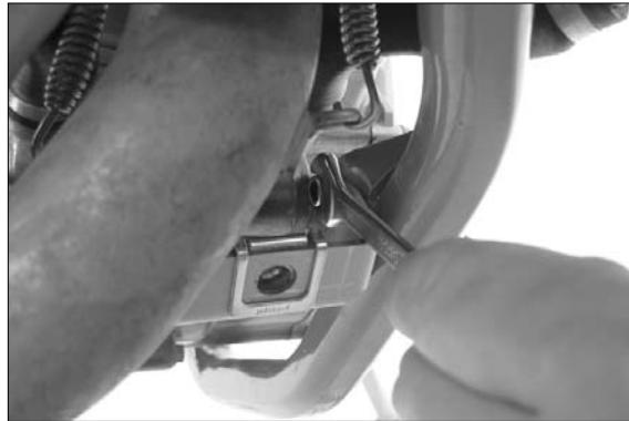
Montare la staffa sul telaio con le viti esagonali e i dadi. Serrare le viti in modo da permettere alla staffa di muoversi.
