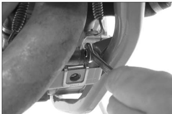
Den Befestigungsbügel mit den Sechskantschrauben und den Muttern am Rahmen montieren. Die Schrauben nur so fest anziehen, dass sich der Bügel noch bewegen lässt.
