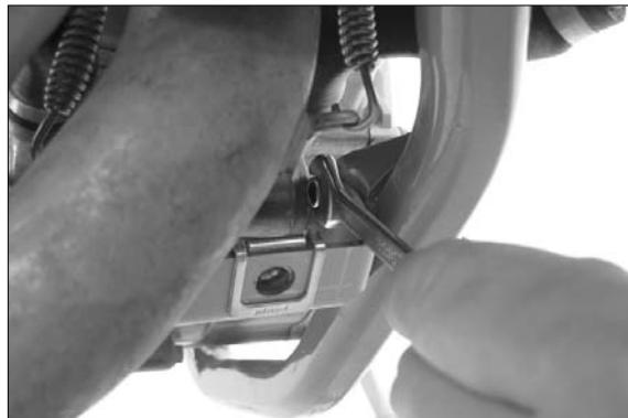
Montar el estribo de sujeción en el chasis, utilizando los tornillos de cabeza hexagonal y las tuercas. Apretar los tornillos a mano, de manera que sea posible todavía mover el estribo de sujeción.
