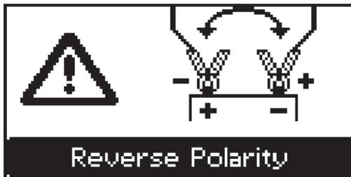
Polarità dei cavi di carica invertita, la protezione contro l'inversione di polarità è scattata.
