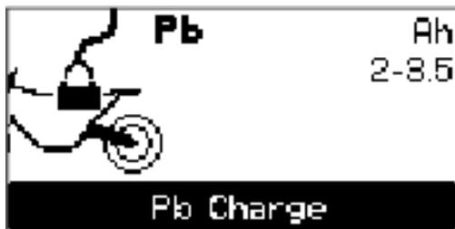
Il caricabatteria si trova in modalità di funzionamento a vuoto. Compare l'indicazione della modalità di funzionamento Pb Charge (Pb Carica).
