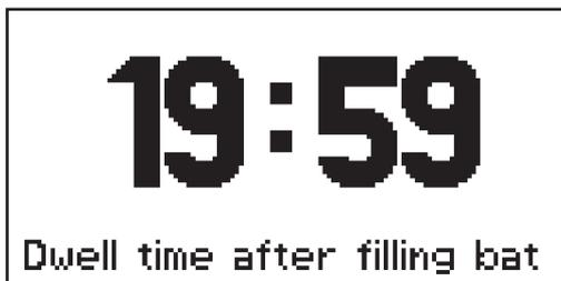
Il caricabatteria riconosce automaticamente il tipo di batteria collegata e avvia il conto alla rovescia di mantenimento di 20 minuti.
