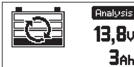
Mentre la analizza, l'apparecchio monitora la tensione della batteria e il risultato di tale analisi servirà al successivo processo di carica.
