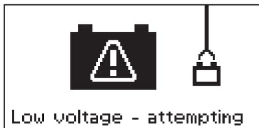
Per le batterie al piombo più che completamente scariche viene visualizzata l'avvertenza "Low voltage - attempting" (Tensione bassa - Tentativi di). Attivare questa modalità di funzionamento con il tasto Stop / Start.
