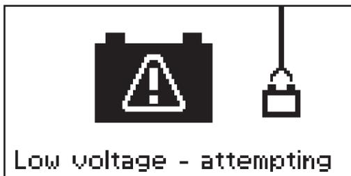
Per le tensioni delle batterie inferiori a 8,4 V viene visualizzato un messaggio che consiglia la modalità di funzionamento "Pb Refresh" (Pb Desolfatazione).
