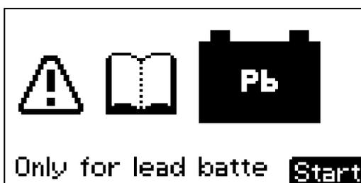
Viene visualizzata l'avvertenza che la modalità di funzionamento "Pb Refresh" (Pb Desolfatazione) è consentita solo per le batterie al piombo.
